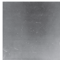
图4 压制温度为 200^{\circ}\text{C} 时 TPU 薄膜外观形貌
